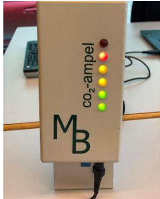
Abbildung 20: Messensor mit Ampelfunktion zur vereinfachten Visualisierung des CO 2 -Gehalts
